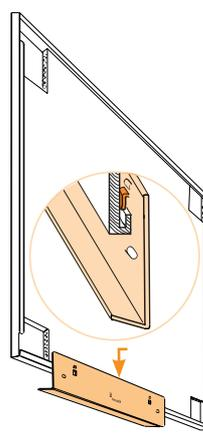
Stiftablage an der Rückseite der Tafel vormontieren.
