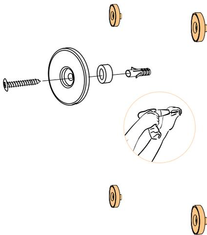
Magnethalterungen wie abgebildet montieren.
