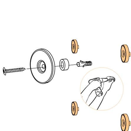
Magnethalterungen wie abgebildet montieren.
