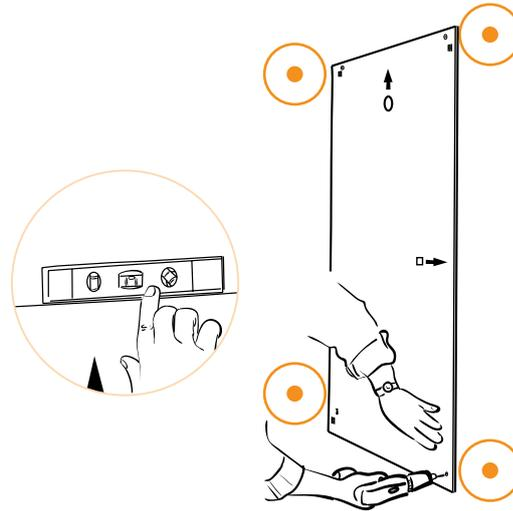
...mit einer Wasserwaage ausrichten.
