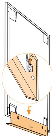
Stiftablage an der Rückseite der Tafel vormontieren.
